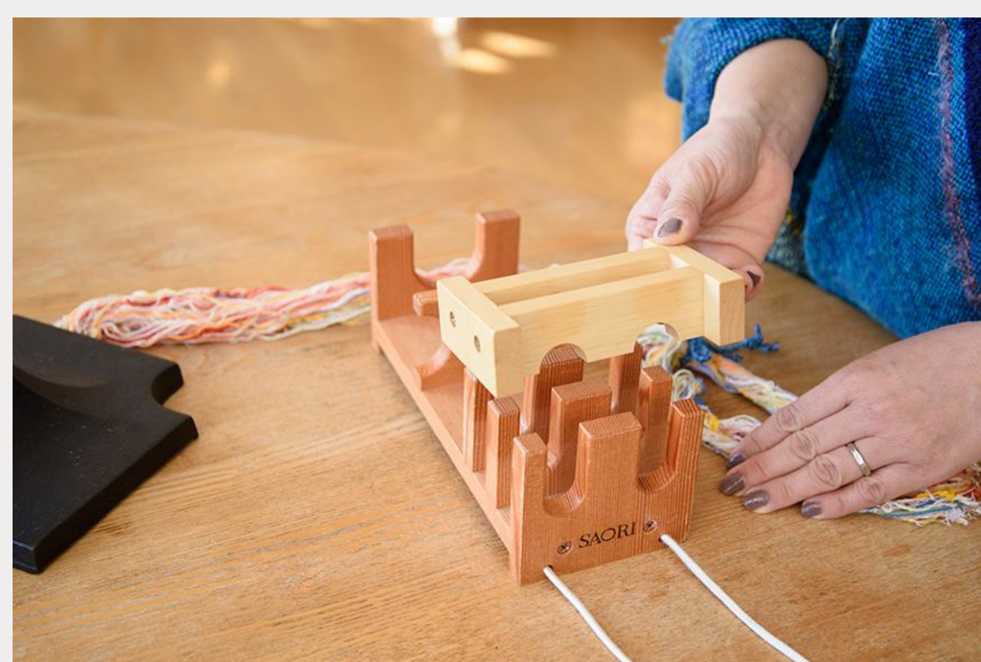
①タテ糸を重りで押さえ、綾ホルダーの準備をします。
