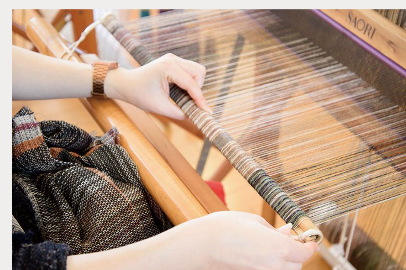
④タテ糸を引き出し、くるくると巻いてチューブをつけたらセット完了です。
