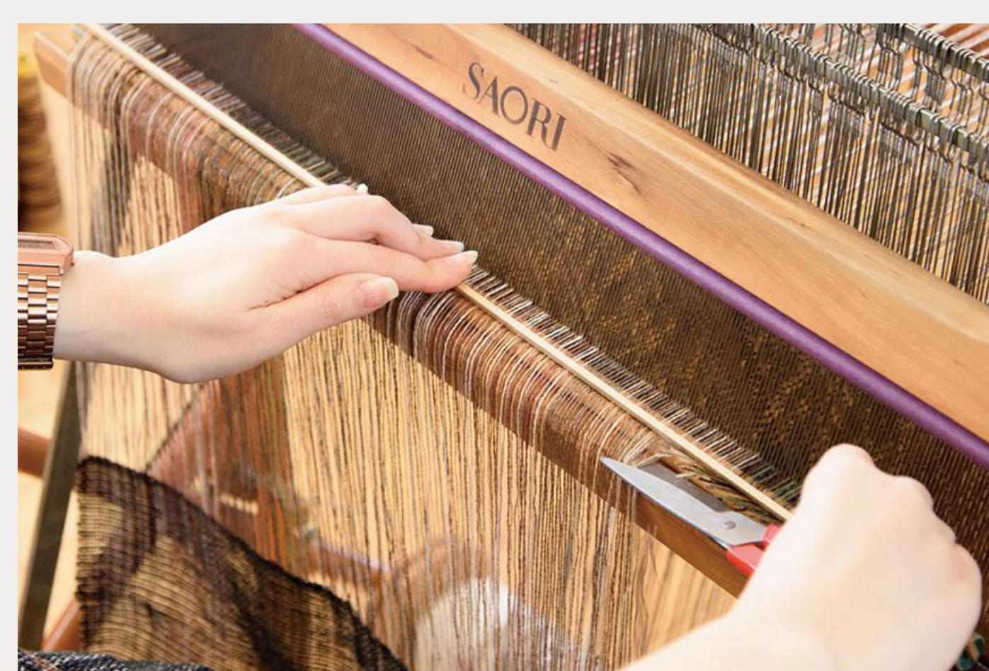
③くさび板を押さえながらタテ糸を切ります。
