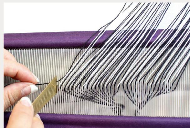
「旧式整経」は、以下の手順で行う方法です。①整経台を使った「糸掛け」、②綾ホルダーと箆通し板を使った「箆通し」、③経通し棒を使った「綜統通し」、④手織機での「巻き取り」、⑤織り付け棒または布への「織り付け」。さをり織り発祥当時から、テキスト『わたしの手織りSAORI』に掲載されてきた整経方法で、現在も脈々と受け継がれている整経方法です。
