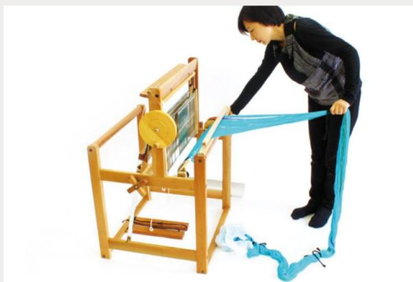
タテ糸づくりが飛躍的に簡単になる「城研三式整経」をする場合のセットです。従来の整経方法とは異なり、①糸掛け、②巻き取り、③経通しの順番でタテ糸を創るので、どんな糸でもスムーズに効率的にタテ糸が完成します。手織適塾SAORIでは、この「城研三式整経」をスタンダードなタテ糸づくりの方法として採用しています。手順は、テキスト『SAORIの技法②【応用編】』で詳しく紹介しています。
