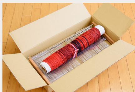
タテ糸セットの入れ替えに必要です。延長用紙管があると、タテ糸セット（箄・綜統棒・タテ糸）を入れ替えるので、1台の織機で複数の作品を並行して織ることができます。
