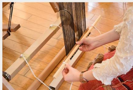
ガムテープをつけたまま、溝付き織り付け棒を手前から上方向に回転させ押さえ板が下向き状態で織り付けヒモのチューブを差込みます。
