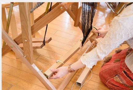
タテ糸ローラー巻きの最後についているガムテープを剥がし、延長用紙管と付け替えます。
