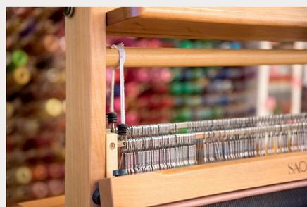
回転防止ストッパーが装着済み！綜統枠の取り付け・取り外しがとても簡単にできます。
