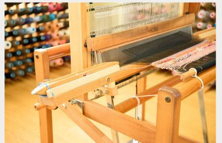
シャトル受け棚や手動開口装置など、体の不自由な方のための補助部品を取り付けることができます。
