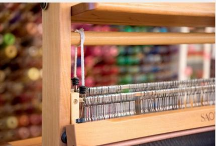
回転防止ストッパーが装着済み！綜絢枠の取り付け・取り外しがとても簡単にできます。
