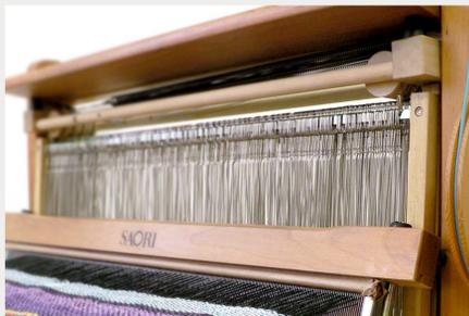
4枚枠セットを取り付けて4枚枠モデルに変更できます。
