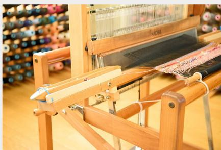
シャトル受け棚や手動開口装置など、体の不自由な方のための補助部品を取り付けることができます。
